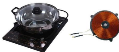
图14.24 电磁灶及其高频载流线圈
