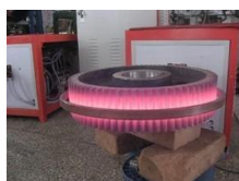
图14.23 用涡电流对齿轮进行淬火
